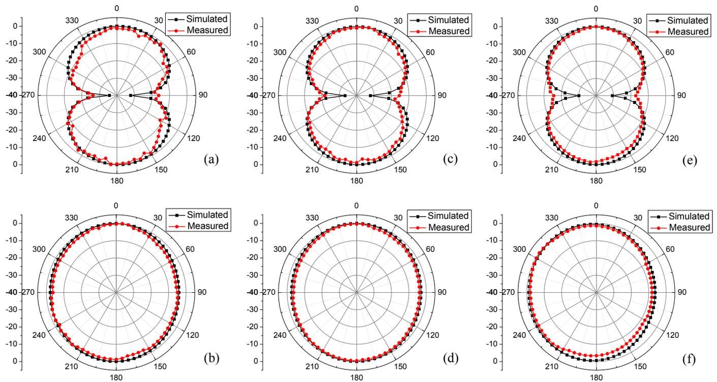
Fig. 7 Simulated and measured radiation patterns: (a)  $yz$ -plane at 3.85 GHz; (b)  $xz$ -plane at 3.85 GHz; (c)  $yz$ -plane at 4.5 GHz; (d)  $xz$ -plane at 4.5 GHz; (e)  $yz$ -plane at 6.5 GHz; (f)  $xz$ -plane at 6.5 GHz;
